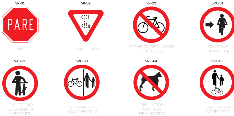
Figura 79. Señales reglamentarias del Manual de Señalización Vial con el nuevo pictograma propuesto
