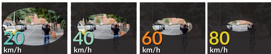
Figura 10. Campo visual según velocidad del vehículo. Elaboración propia a partir de datos de Bartmann, Spijkers, & Hess (1991).
