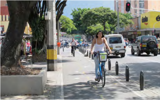
Foto 42. Ejemplo de segregación/protección con bolardos (Medellín)
