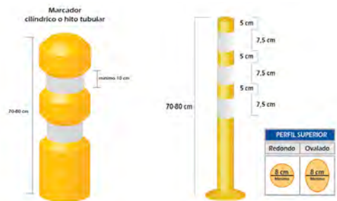
Figura 99. Delineadores tubulares simples. Fuente: Manual de señalización de Colombia (2015)
