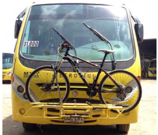
Foto 58. Soporte de bicicletas utilizado temporalmente en MetroSinú, Montería. Fuente: Gustavo Gómez.
